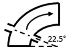
Pipe Elbow Meter
